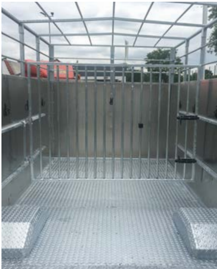
Trenngitter aus Stahl (verzinkt) inkl. Lochschiene, Anbinderinge, sowie Spriegelaufbau ohne Plane
