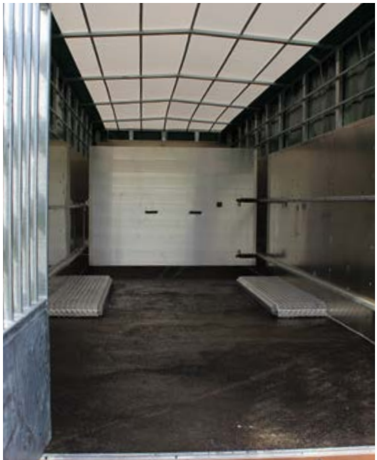
Trennwand aus Aluminium inkl. Lochschiene, sowie Plane inkl. Lichtband
