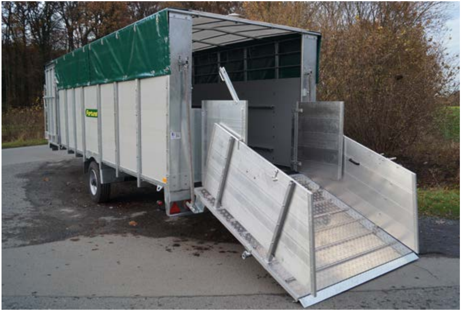
Auflauframpe mit Aluminiumtränenblech inkl. Aufkantungen, Treibwänden aus Aluminium und eine Endwand aus Aluminium als Flügeltür
