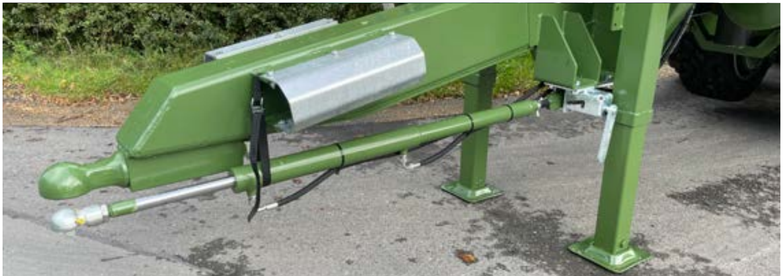
Zwangslenkung inkl. Schnellverriegelung (zwingend erforderlich)
