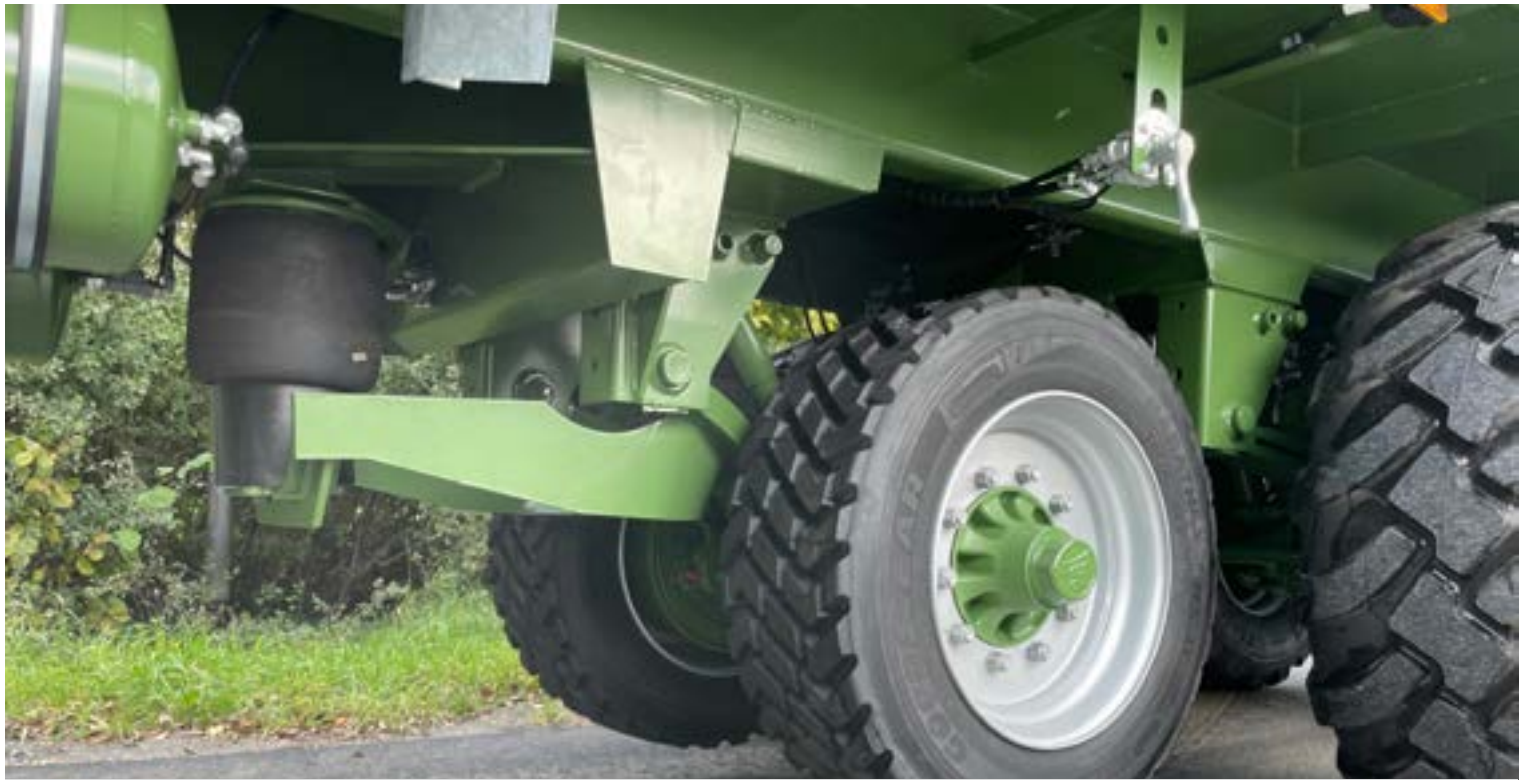
Achslift für die Hilfsachse
