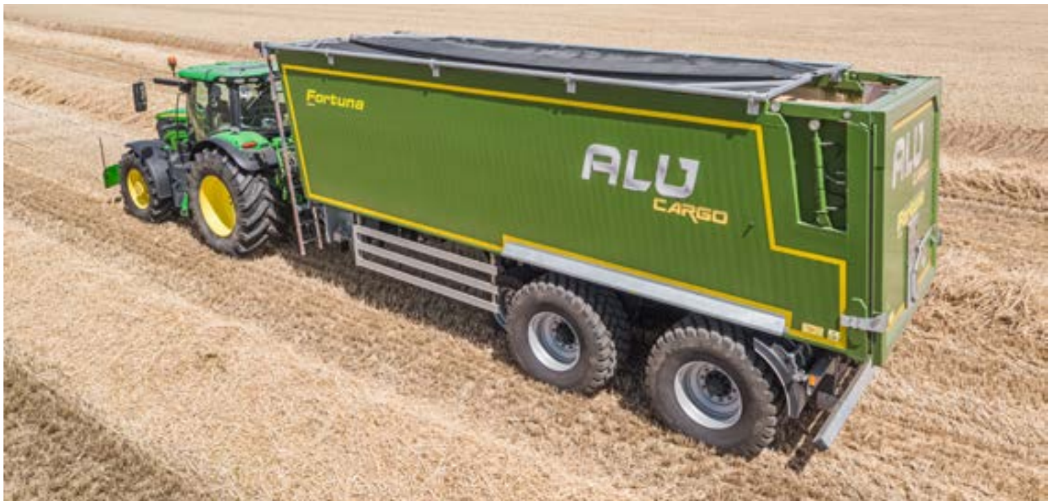
Abdeckung System „Fliegenklatsche“ geschlossen
