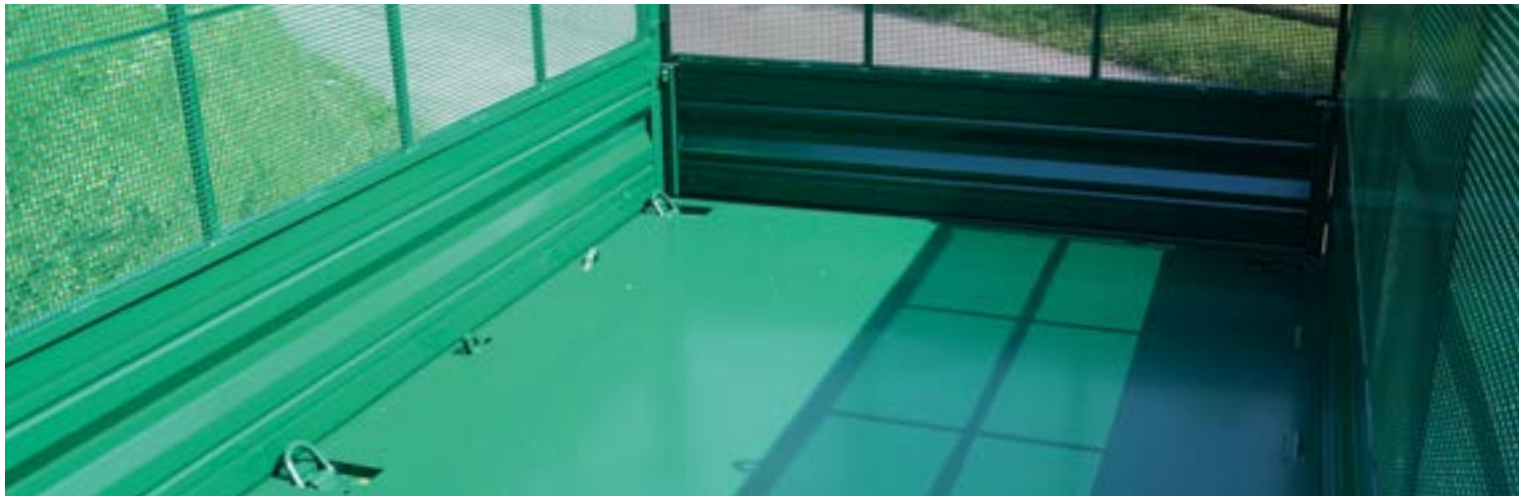
Laubgitteraufbau als Lochgitter / Zurringe in den Boden einschwenkbar nach UVV, Zurrkraft 4000 daN
