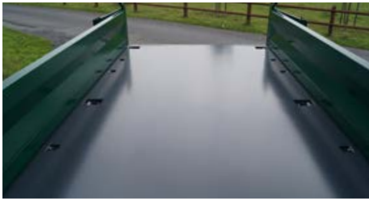
eingelassene Zurringe (nach UVV) mit einer Zurrkraft je Stück von 2.500 daN oder 10.000 daN
