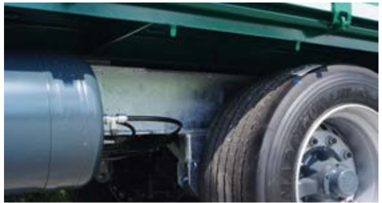
Fahrgestell in verzinkter Ausführung, Netzhaken (innen) am Außenrahmen der Kippbrücke angebracht
