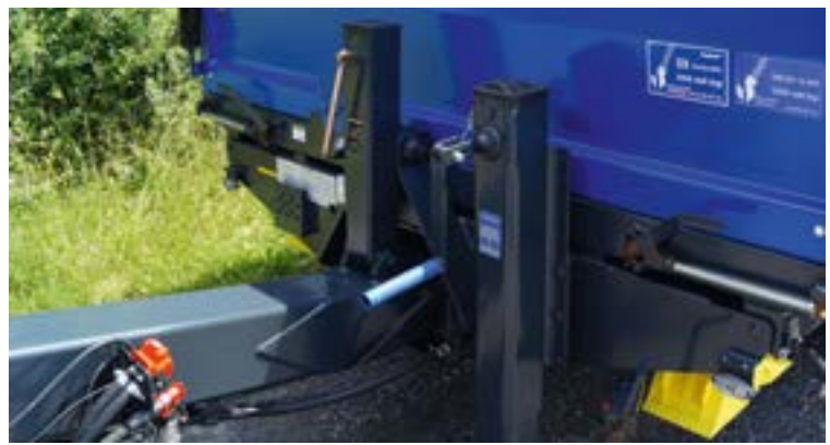
Zugdeichsel durch Getriebewinde von 650 - 1050 mm höhenverstellbar
