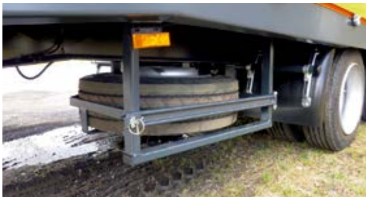
Reserveradhalter in Korbform unter dem Fahrgestell
