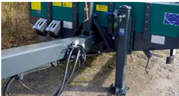
10 t Jost® Stützwinde mit Last- und Schnellgang, Fußplatte teleskopierbar
