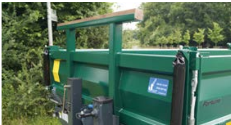
Stirnwandablagebock z.B. für Baggerschaufeln
