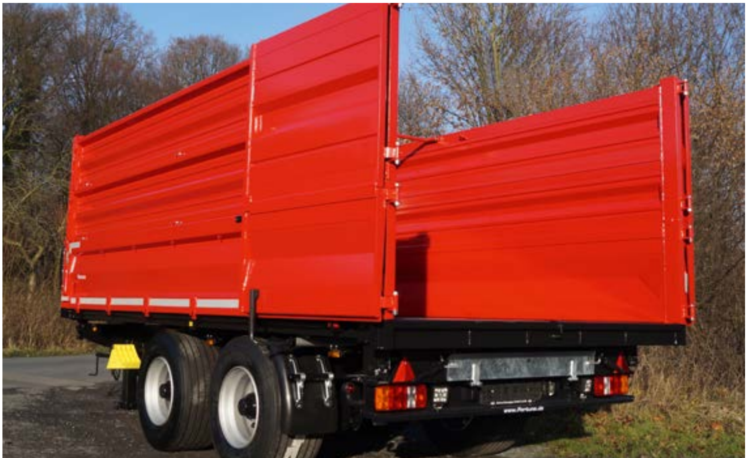
Bordwand 600 mm hoch aus Hardox, zusätzliche Stahlpendelaufsatzwände 600 mm und 600 mm, inkl. zweiflügeliger Hecktür
