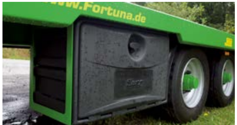
abschließbarer Werkzeugkasten mit Drehriegelverschluss und inkl. Stahlrahmen
