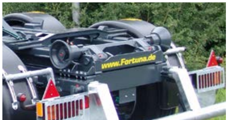
Aufnehmerollen inkl. Bi-Point, für eine optimalere Containeraufnahme
