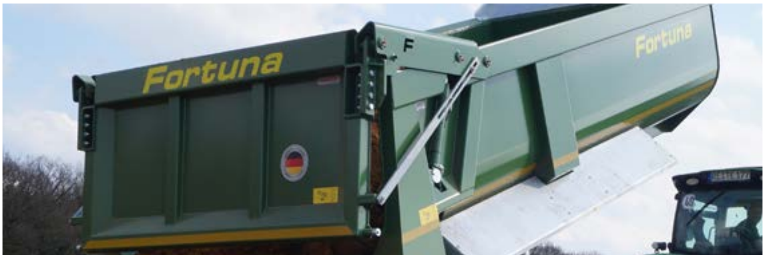
Zwei Flacheisen für die Pendelheckklappe inkl. Langloch (z.B. für Besandung)
