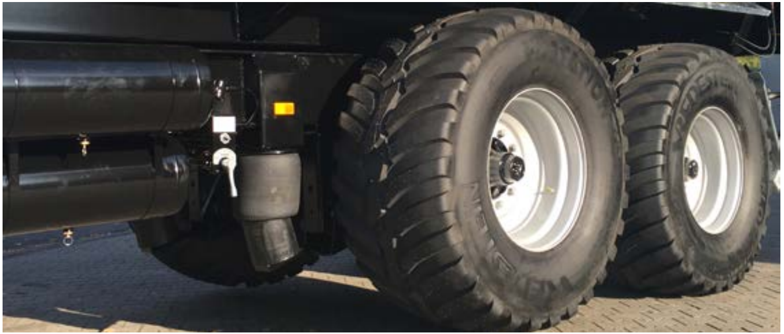
24 t. Luftfederung (verstärkte Einbindung) inkl. Liftachse
