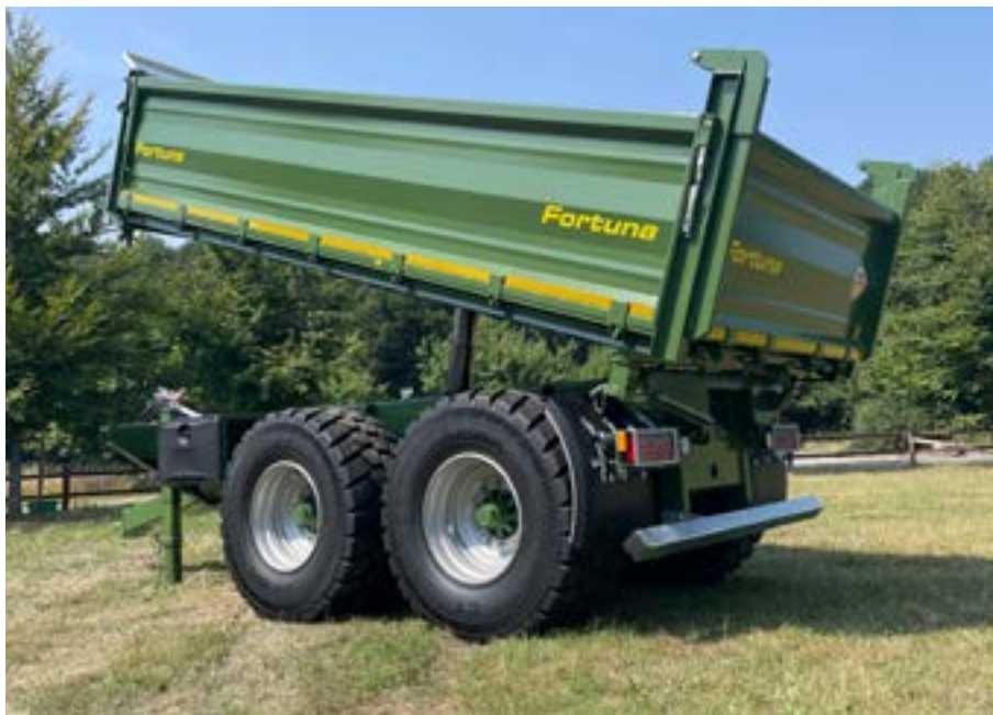
Heckklappe als pendelnde Heckklappe inkl. Drehpunkterhöhung (Verschluss über einen kleinen doppeltwirkenden Hydraulikzylinder)
