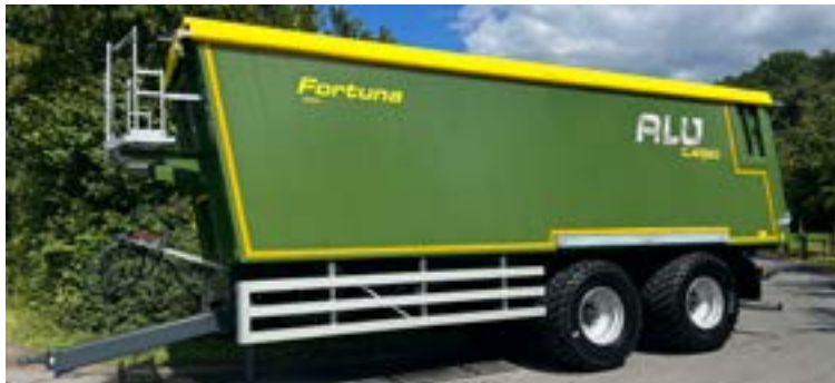
Rollplane (ca. 100 mm hoch) aus PVC Planenstoff (ca. 680 g/m 2 ) inkl. Arbeitsplattform in Front
