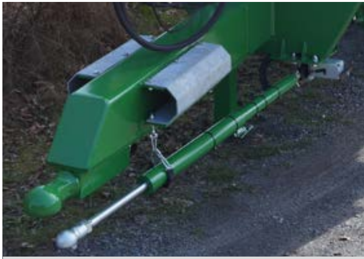
Zwangslenkung (mechanisch-hydraulisch) inkl. Schnellverriegelung der Schubstange
