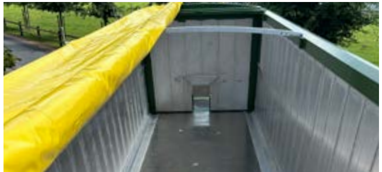
Rollplane (ca. 100 mm hoch) aus PVC Planenstoff (ca. 680 g/m 2 ) inkl. Arbeitsplattform in Front
