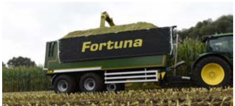
Abdeckung „System Fliegenklatsche“ durch zwei Hydraulikmotoren inkl. Motorbremse, Planenmaterial: Netzplane (schwarz)
