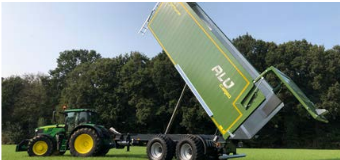
Kippwinkel von 52°, Heckklappe weit nach oben öffnend 90° (frei pendelnd)
