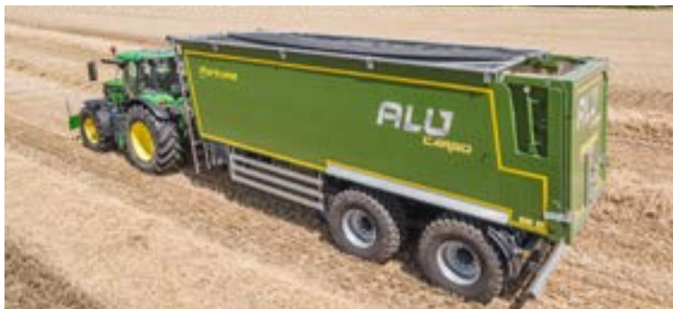
Abdeckung „System Fliegenklatsche“ durch zwei Hydraulikmotoren inkl. Motorbremse, Planenmaterial: Netzplane (schwarz)
