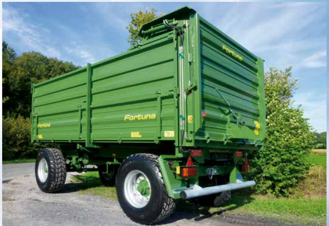
K 140/5.0 mit 600 mm Bordwand, 800 mm Pendelaufsatz und hydraulischer Heckklappe
