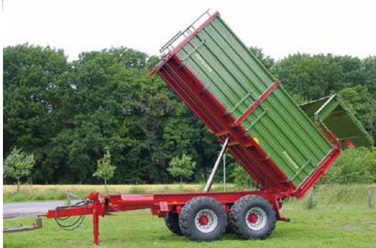
Hohe Stabilität beim Kippvorgang durch weit nach außen verlagerte Kugelkipplager
