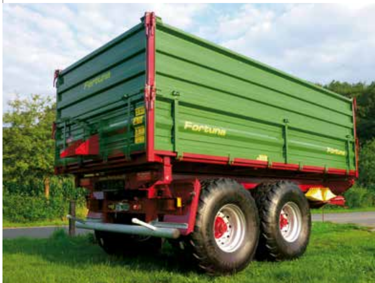
FTD 150/5.0 mit Bordwand 600 mm und Pendelaufsatz 800 mm
