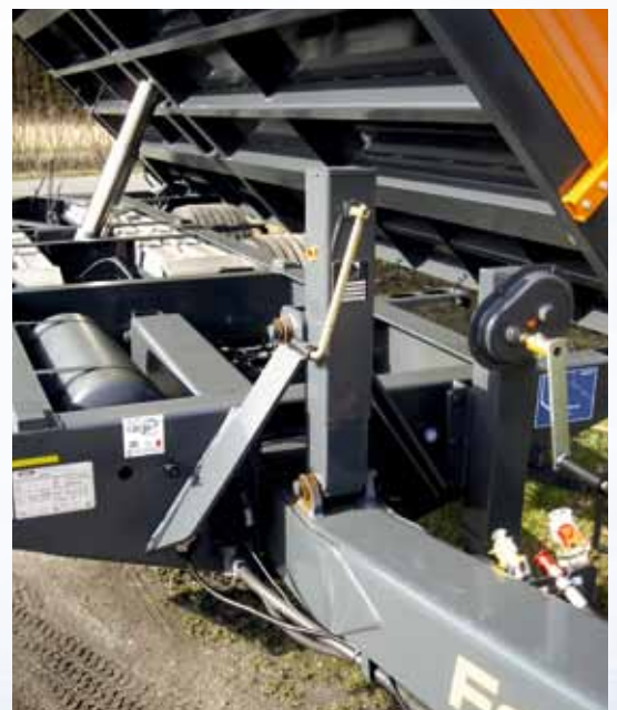
Stufenlos höhenverstellbare Zugdeichsel durch eine Getriebewinde von 650 bis 1.050 mm
