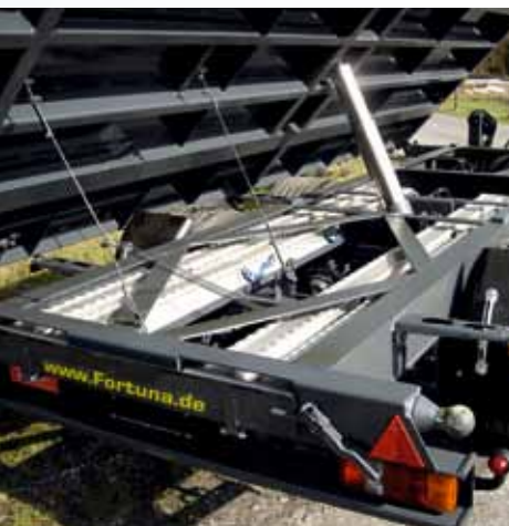
Fahrgestell mit eingebauten Schächten für Auffahrampen inkl. kuggelagerter Führungsrollen
