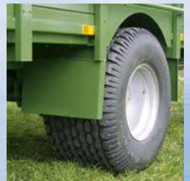
Breite Bereifung (500/50 R 17) für den Einsatz in Feuchtwiesen
