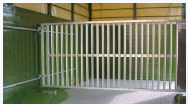
Trenngitter aus Aluminium, versetzbar über Lochschiene
