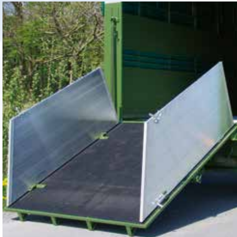
Auflauframpe mit Treibwänden aus Aluminium
