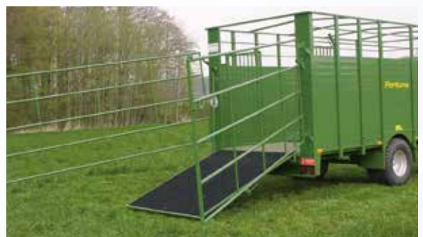
Treibhecken aus Stahl, seitlich schwenkbar
