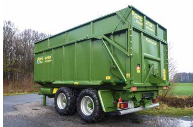
FTM 180 / 5.6 mit niedriger Bereifung und Federn unter den Achsen
