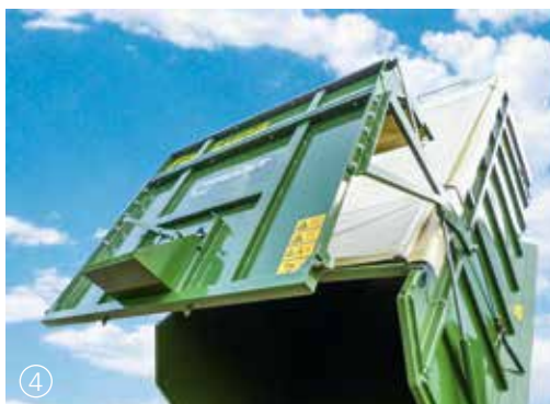
Planensystem Fortuna: Kippen im beplanten Zustand möglich
