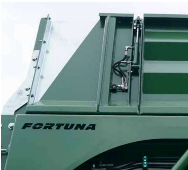
abklappbarer Stahlaufsatz, hinten automatisch hydraulisch verriegelbar (optional)
