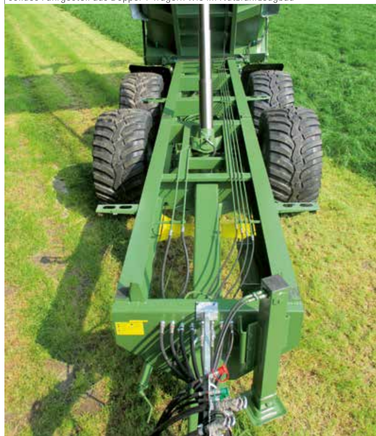
solides Fahrgestell aus Doppel-T-Trägern wie im Nutzfahrzeugbau
