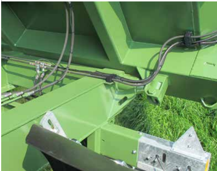
hinten weit nach außen verlegte Kugelkipplager für bessere Stabilität
