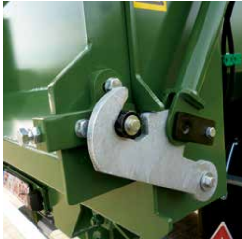
hydraulische Rückwandöffnung inkl. Hakenverriegelung und gelagerten Verschlussbolzen (optional)
