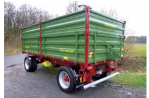
Fortuna-Zweiachs-Dreiseitenkipper vom Typ K 180 / 5.2 kommt mit einer niedrigen Bereifung auf eine Überladehöhe von 2,65 Metern.
