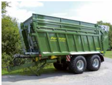
Fortuna Tandem Abschiebewagen Typ FTA 200 / 7.0 mit einer hydraulisch abklappbaren Bordwand
