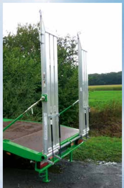
starre Auffahrrampe aus Aluminium inkl. Hebehilfe
