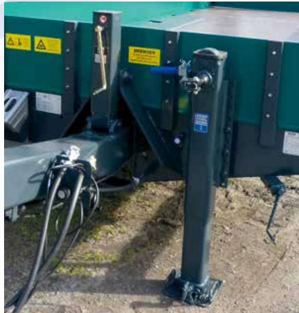
Zugdeichsel durch Getriebewinde von 650 - 1050 mm höhenverstellbar
