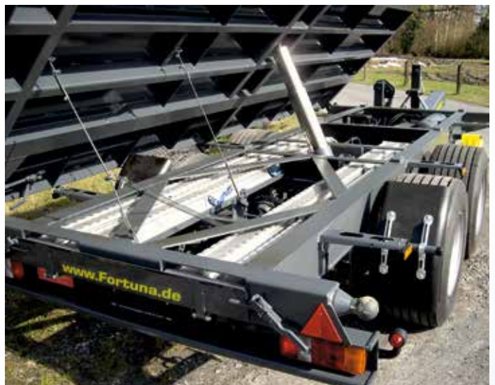
Fahrgestell mit eingebauten Schächten für Auffahrampen inkl. kugelgelagerter Führungsrollen
