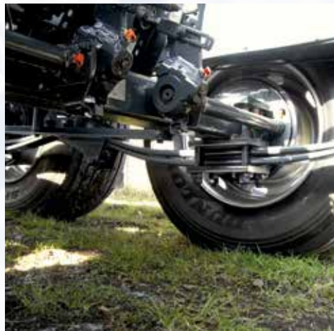
Federn unter den Achsen montiert (für eine niedrigere Ladehöhe)
