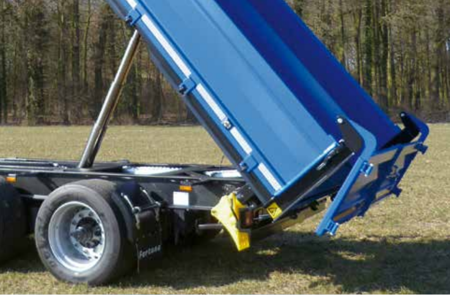
Selbstöffnende und schließende Heckklappe „System Fortuna“
