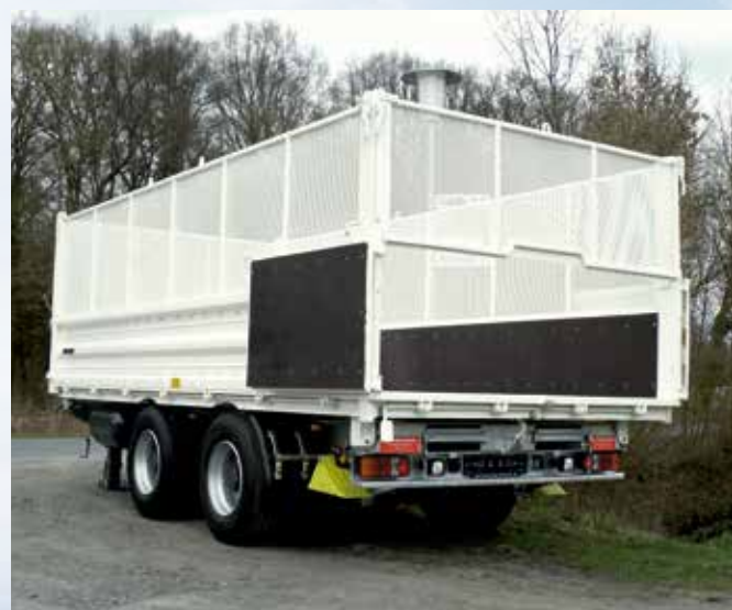
1.000 mm Häckselaufbau und von innen mit einer 9 mm Siebdruckplatte ausgeschlagene Bordwände und eine zweiflügelige Hecktür, Heckwand mit Hechselfaufsatz (pendelnd)
