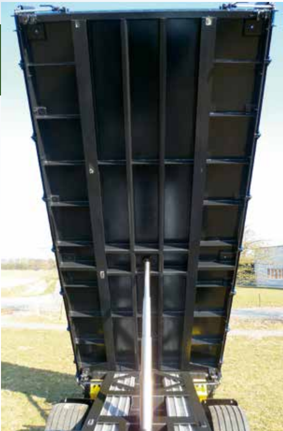
Brückenboden (stark verrippt) für mehr Stabilität
