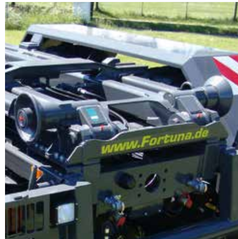
Aufnehmerrollen inklusive Bi-point zur optimalen Containeraufnahme
