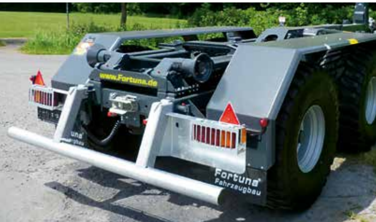
Ausziehbarer Unterfahrtschutz in verzinkter Ausführung für verschiedene Containerlängen
