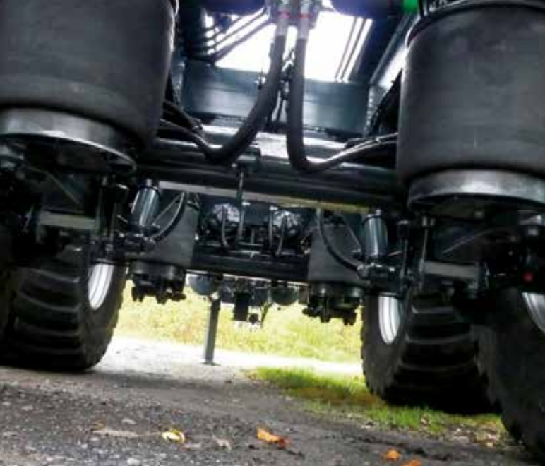
Luftfederung mit einem Ventil für das Heben und Senken inklusive Schnellentlüftung (serienmäßig)
