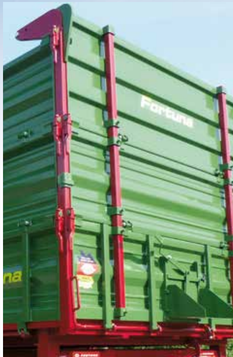
selbstöffnende und schließende Heckklappe „System Fortuna“ inkl. Drehpunkterhöhung und Silorungen
