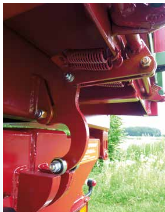
Mechanik der Selbstöffnung, die beim Kippvorgang die Heckklappe mechanisch öffnet und schließt.
