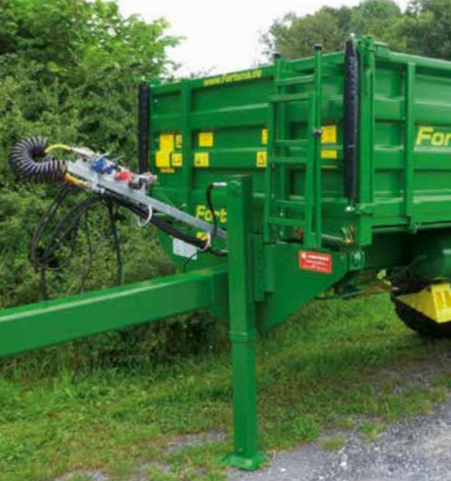
Der hydraulische Stützfuß sowie Bordwandhebefedern sind als Variante erhältlich.
