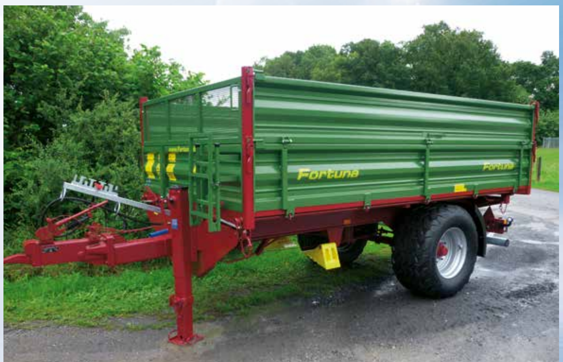
FED 80 / 4.3 mit Aufaufbremse und einem zulässigen Gesamtgewicht von 8.000 kg
