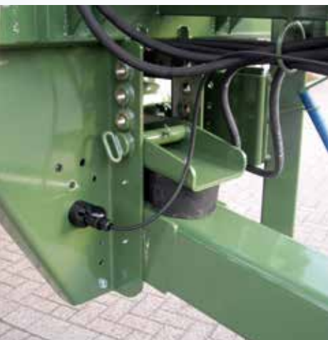
schwingungsgedämpfte und höhenverstellbare Zugdeichsel
