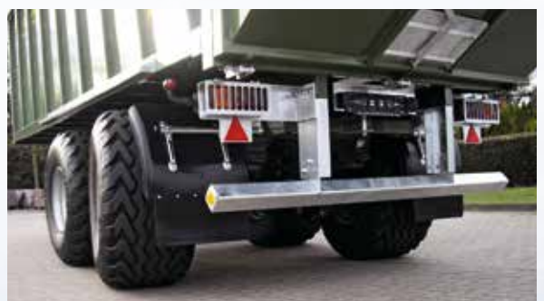
stabiler Unterschutz in verzinkter Ausführung, schraubbar
