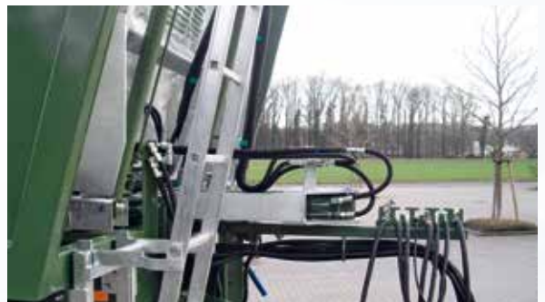
kompaktes Abschiebesystem mit geringem Überhang
