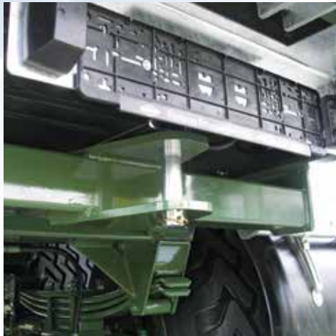
stabile Abschleppzugöse am Heck, für den schweren Einsatz
