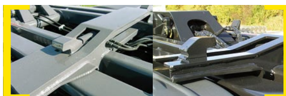
Containerverriegelung – innen oder außen
