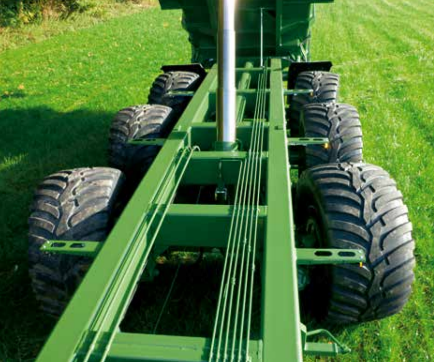
breiter Fahrgestellrahmen mit angelenkter erster und dritter Achse
