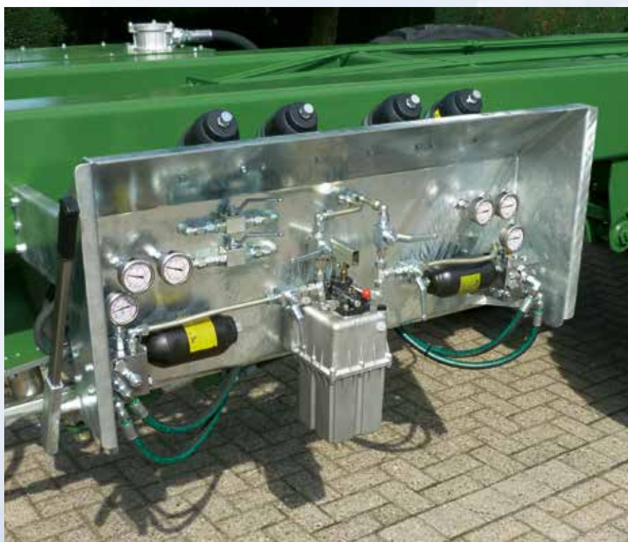
Zwangslenkung „System Schamüller“ für zwei Lenkachsen mit Überströmventilen inkl. Membranspeichern
