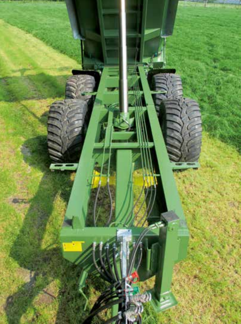
solides Fahrgestell aus Doppel-T-Trägern wie im Nutzfahrzeugbau
