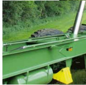
solides Fahrgestell aus Doppel-T-Trägern wie im Nutzfahrzeugbau
