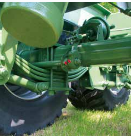
Federn unter den Achsen, für eine 32 t. Parabelfederung (mit Längslenkern)
