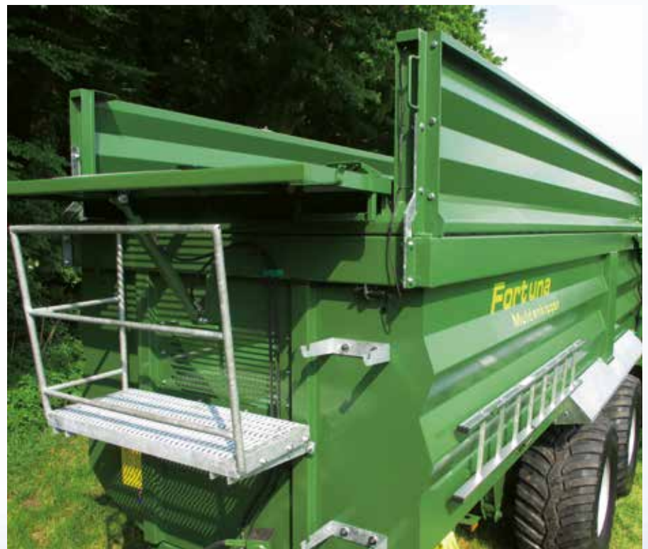
hydraulisch abklappbare Stirnwand sowie Arbeitsplattform sind optional erhältlich
