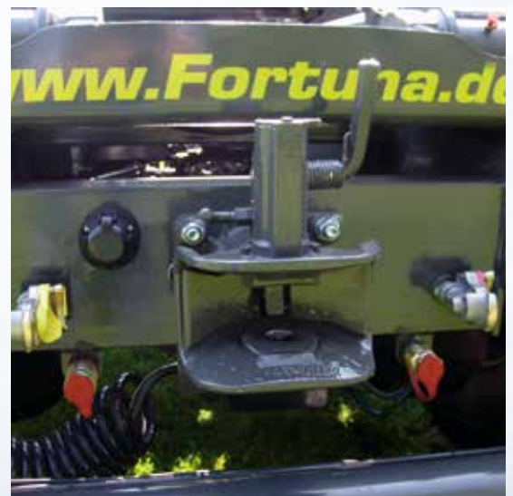
Automatische Anhängerkupplung mit Stützlast, sowie Öl- und Luftdurchtrieb
