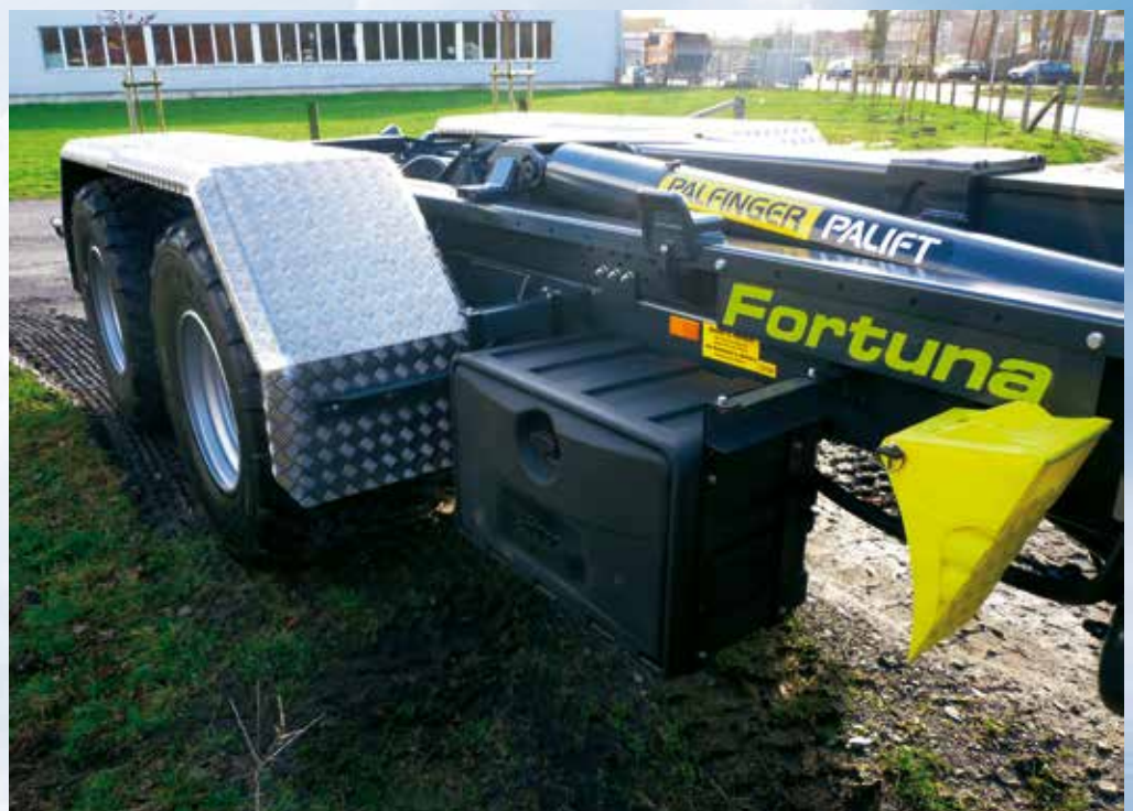
Werkzeugkasten aus Kunststoff sowie Kotflügel aus Aluminium-Riffelblech sind optional erhältlich
