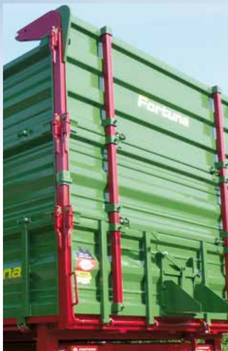
selbstöffnende und schließende Heckklappe „System Fortuna“ inkl. Drehpunkterhöhung und Silorungen
