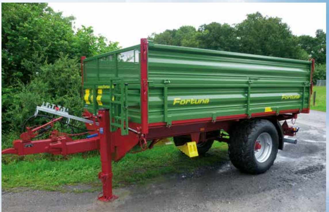
FED 80 / 4.3 mit Auflaufbremse und einem zulässigen Gesamtgewicht von 8.000 kg
