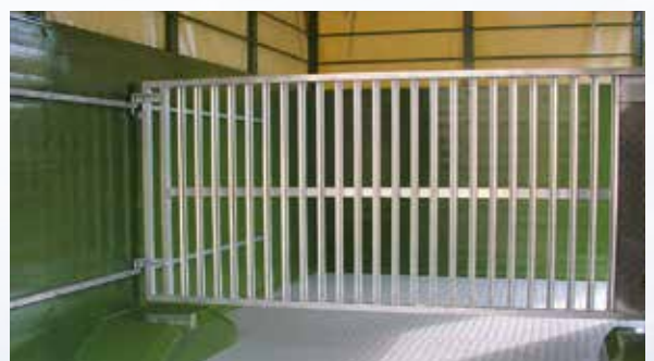
Trenngitter aus Aluminium, versetzbar über Lochschiene
