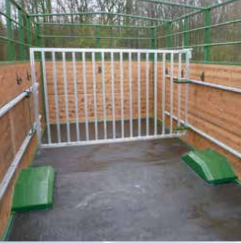
Ein Trenngitter und der Stahltränenblechboden mit Gummiestrich vergossen
