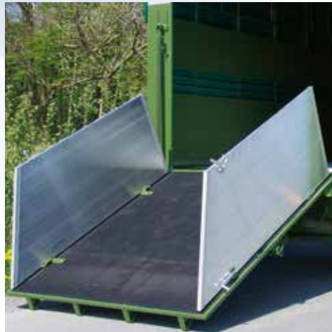
Auflauframpe mit Treibwänden aus Aluminium
