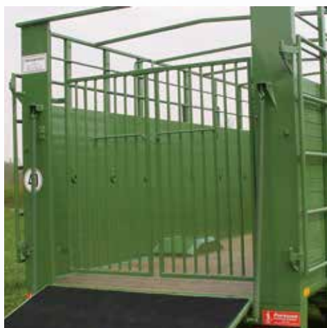
Einstellbare Hebefedern für die Auflauframpe und ein Endgitter als Flügeltür für Großvieh
