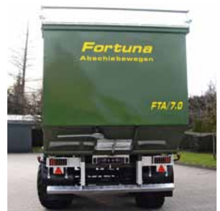
Aufsatz für die Großraumrückwand inklusive Hebelmechanik
