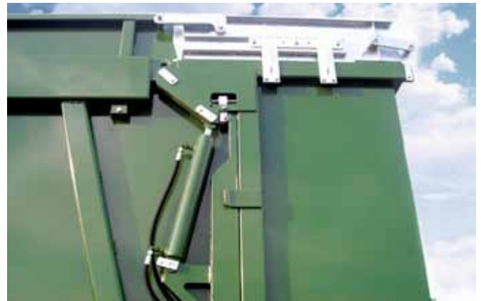
Aufsatz für die Großraumrückwand inklusive Hebelmechanik
