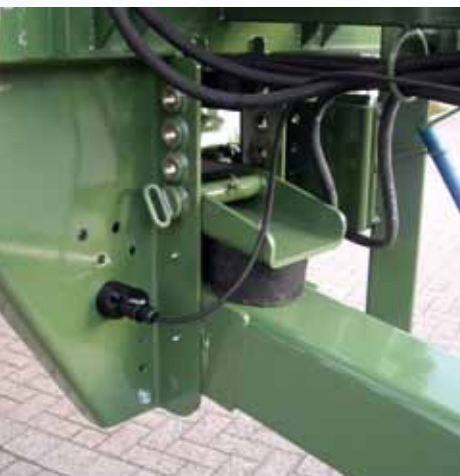
schwingungsgedämpfte und höhenverstellbare Zugdeichsel
