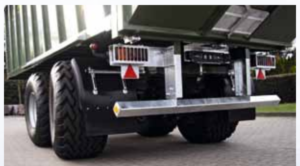
stabiler Unterschutz in verzinkter Ausführung, schraubbar
