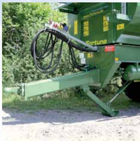
Hydraulischer Schleppfuß inkl. Untenanhängung
