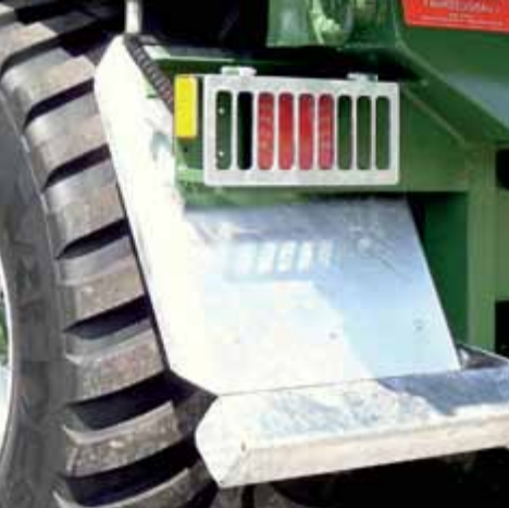
Verzinkte Kotflügel und Unterfahrerschutz inkl. LED-Beleuchtung (optional)
