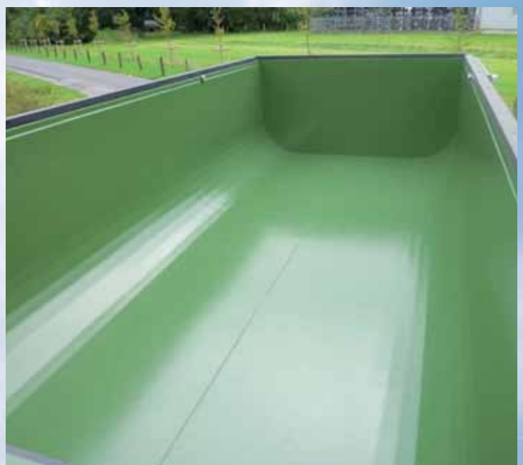
Kunststoffleiste auf dem Muldenrand (optional) und eine breite und ebene Muldenform
