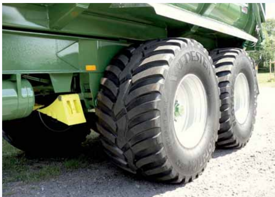
Verzinkte Kotflügel über der Bereifung 650/50 R 26.5
