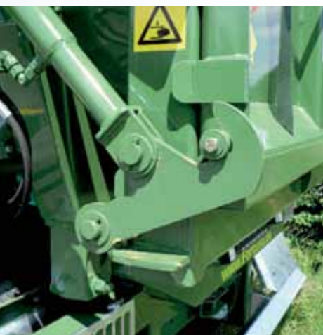
Hydraulische Rückwandöffnung inkl. Hakenverriegelung und gelagerten Verschlussbolzen (optional)
