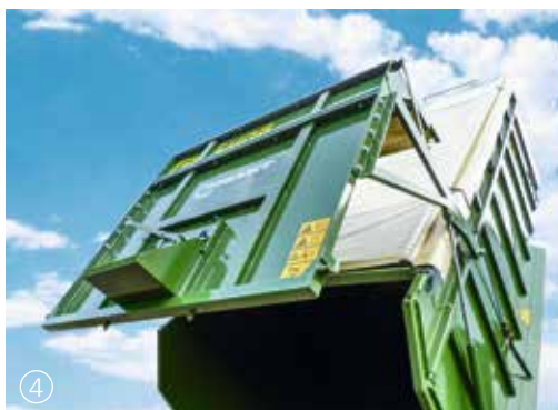
Planensystem Fortuna: Kippen im beplanten Zustand möglich
