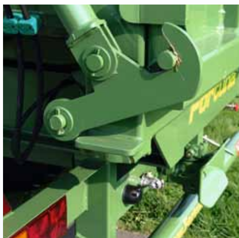
Hydraulische Heckklappe mit automatischer Hakenverriegelung
