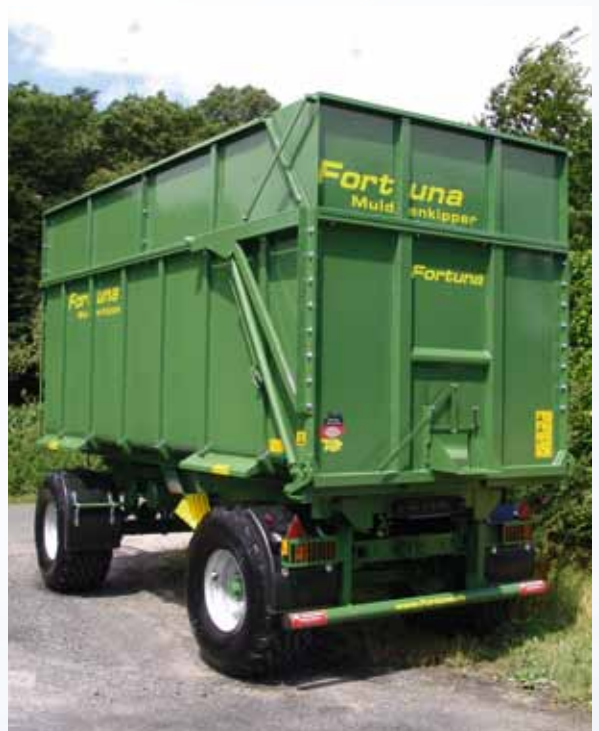
Hydraulische Heckklappe mit Kornschieber, Muldenaufsatz mittig geteilt
