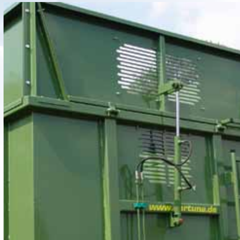
Hydraulisch abklappbarer Stirnwandaufsatz
