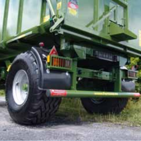
Unterfahrtschutz, LKW Rückleuchten mit Schutzgitter, Spurbegrenzungs- leuchten
