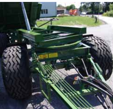
Verkröpfter Rahmenträger zum Drehkranz
