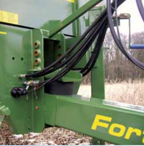
Höhenverstellbare und schwingungsgedämpfte Zugdeichsel
