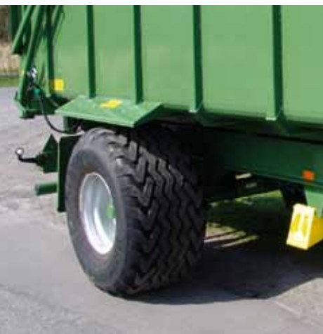
Extrem breite Bereifungen bis 800/45 R 26.5 möglich
