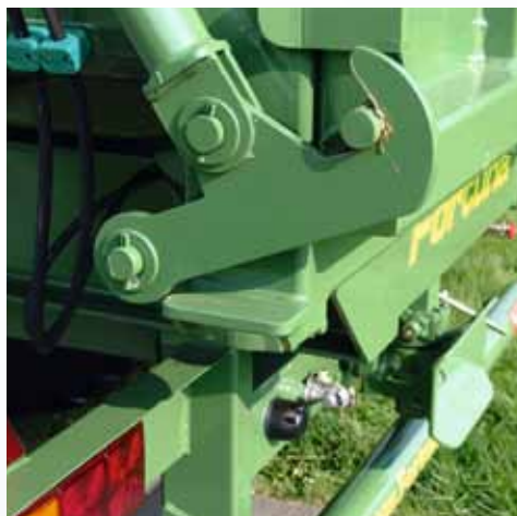
Hydraulische Verriegelung der Heckklappe
