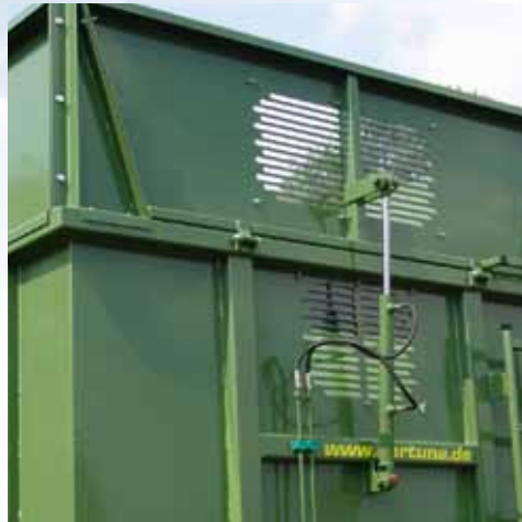
Hydraulisch abklappbarer Stirnwandaufsatz
