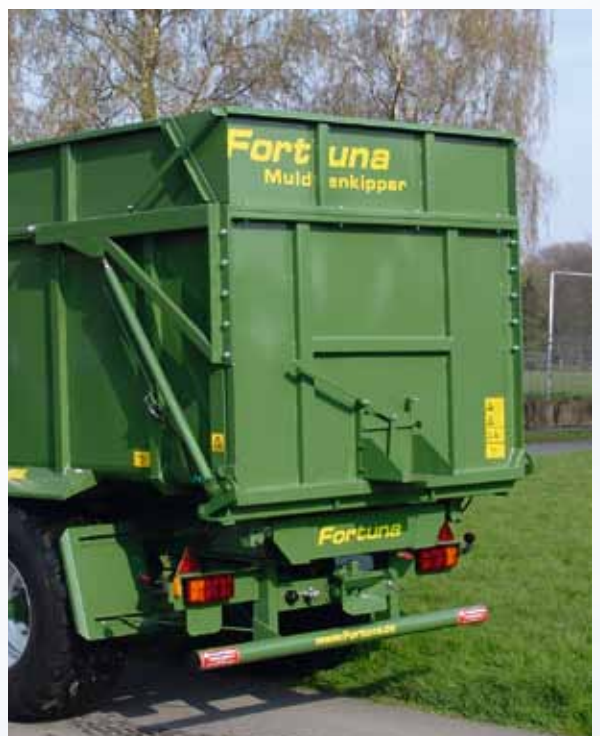
Hydraulische Heckklappe mit Aufsatz, Kornschieber inklusive Hebel und Schütte
