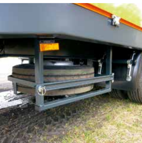
Reserveradhalter in Korbform unter dem Chassis
