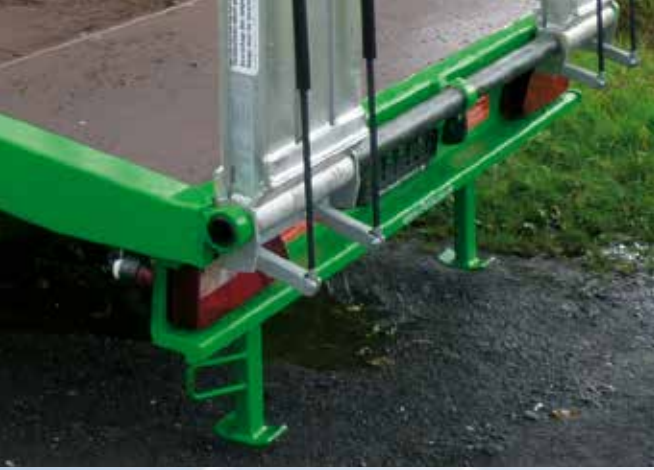
klappbare Abstellstützen hinten
