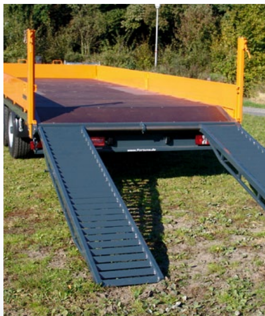
Ladefläche nach hinten abgeschrägt und die Auffahrampen auf der Welle verschiebbar
