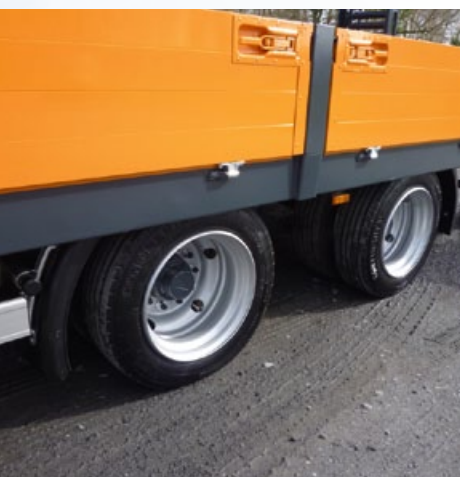
Seitenwände aus Aluminium zusätzlich geteilt und eine niedrige Bereifung 205/65 R 17.5
