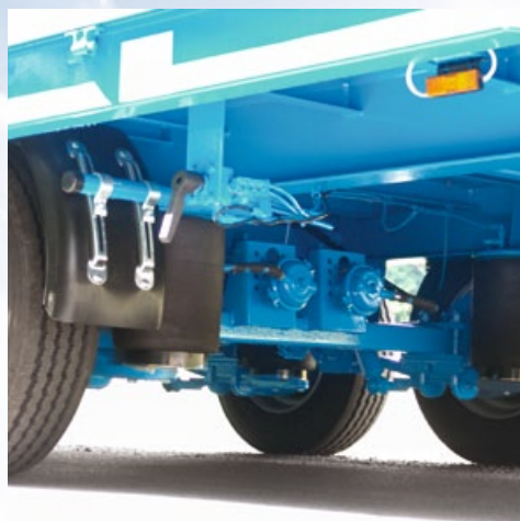
Luftfederung inkl. Ventil für Heben und Senken
