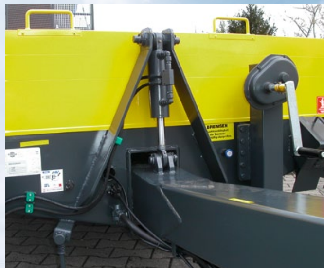
hydraulisch höhenverstellbare Zugdeichsel durch eine Handpumpe
