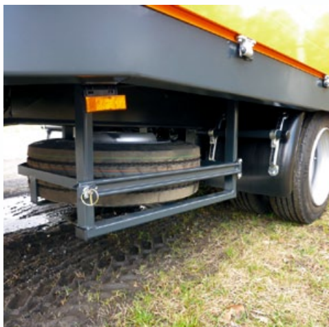
Reserveradhalter in Korbform unter dem Chassis
