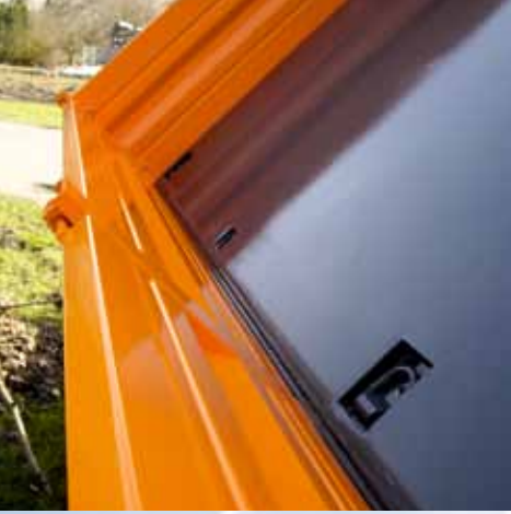
Zurringe nach UVV im Boden eingelassen, 2.500 daN oder 12.000 daN
