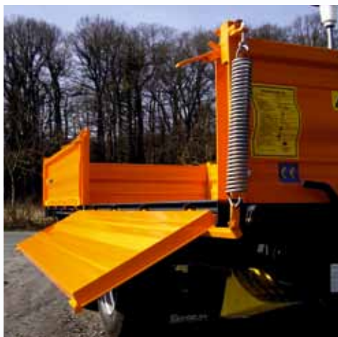
Bordwandhebefebern für die Bordwände, justierbar
