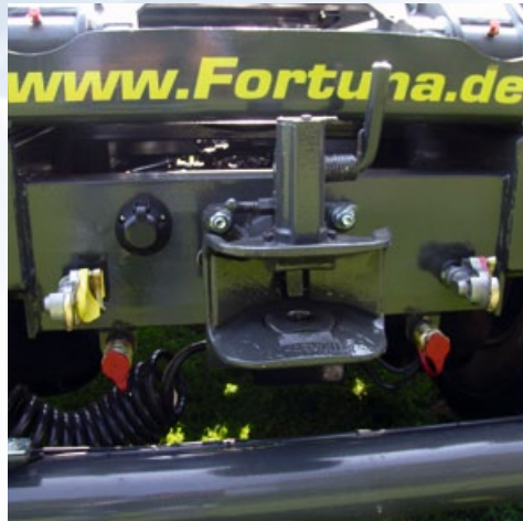
Automatische Anhängerkupplung mit Stützlast, sowie Öl- und Luftdurchtrieb
