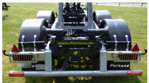
Ausziehbarer Unterfahrtschutz in verzinkter Ausführung für verschiedene Containerlängen
