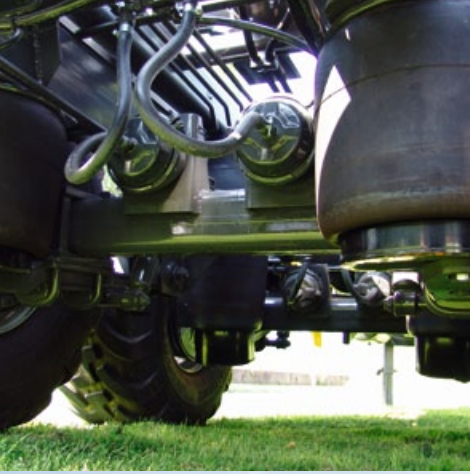
Luftfederung mit Heben und Senken für Fahrkomfort und Funktionalität
