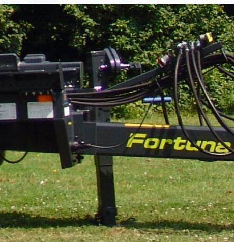
Gefederte Zugdeichsel für besseren Fahrkomfort, wahlweise auch höhenverstellbar
