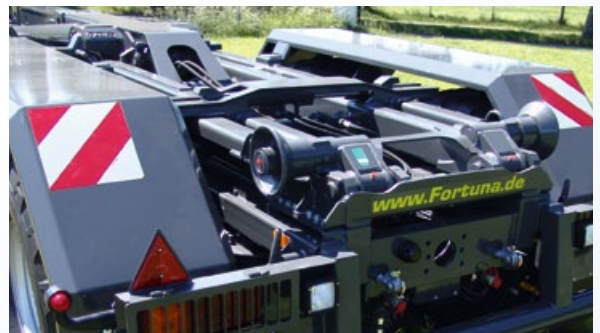
Heckansicht, Aufnahmerollen für Container oder Mulden
