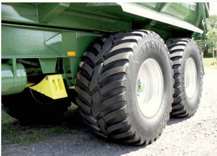
Verzinkte Kotflügel über der Bereifung 650/50 R 26.5
