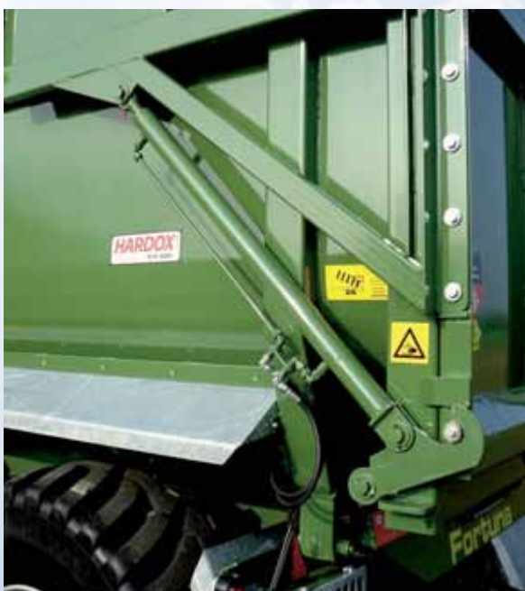
Hydraulische Heckklappe inkl. Hakenverriegelung
